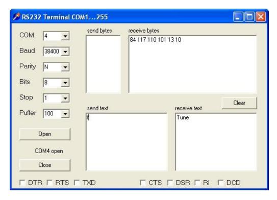
Hier wird der Elektor-DSP-Empfänger aus Heft 7/8-2010 angesteuert. Für die Kommunikation ist die Textübertragung mit 38400 Baud definiert. Das Kommando f88800 stellt den Empfänger auf die UKW-Frequenz 88,8 MHz ein. Auf das kleine "f" reagiert der Empfänger mit der Antwort "Tune". Danach folgt der Zahlenwert (Freqeunz in kHz) und Enter. Alle eingegebenen Zeichen werden als Echo vom Empfänger zurückgesendet. Man kann also sehen, dass alles richtig angekommen ist.
