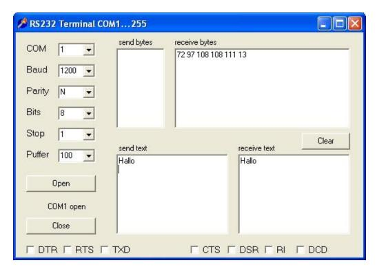
COM1 ist jetzt mit 1200 Baud geöffnet. Verbinden Sie für einen ersten Test TXD (Pin3) mit RXD (Pin 2). Senden Sie einen Text. Jedes in das Text-Fenster eingegebene Zeichen wird sofort gesendet und wieder empfangen. Im Byte-Fenster sehen Sie die Darstellung der ASCII-Zeichen.
