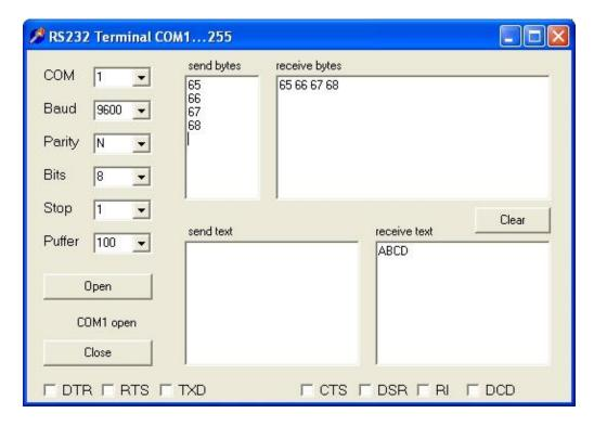
In einigen Fällen müssen Einzelbytes gesendet werden. Geben Sie jeweils eine Zahl ins Byte-Fenster ein und bestätigen Sie die Eingabe mit Enter. Das Byte wird gesendet und wieder empfangen. Auch diesmal kommen beide Darstellung, die Bytes im Byte-Fenster und zu zugehörigen Textzeichen im Text-Fenster. Die Zeichen A...D werden bekanntlich durch die ASCII-Werte 65 ... 68 repräsentiert.
