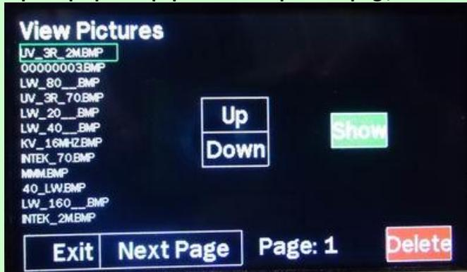
**USB HS Cardrdr** - Просмотр записанных изображений на компьютере. Можно стирать, копировать в компьютер, изображения которые находятся на SD карте AA. Прибор к компьютеру подключается кабелем через микро USB-HS AA.
