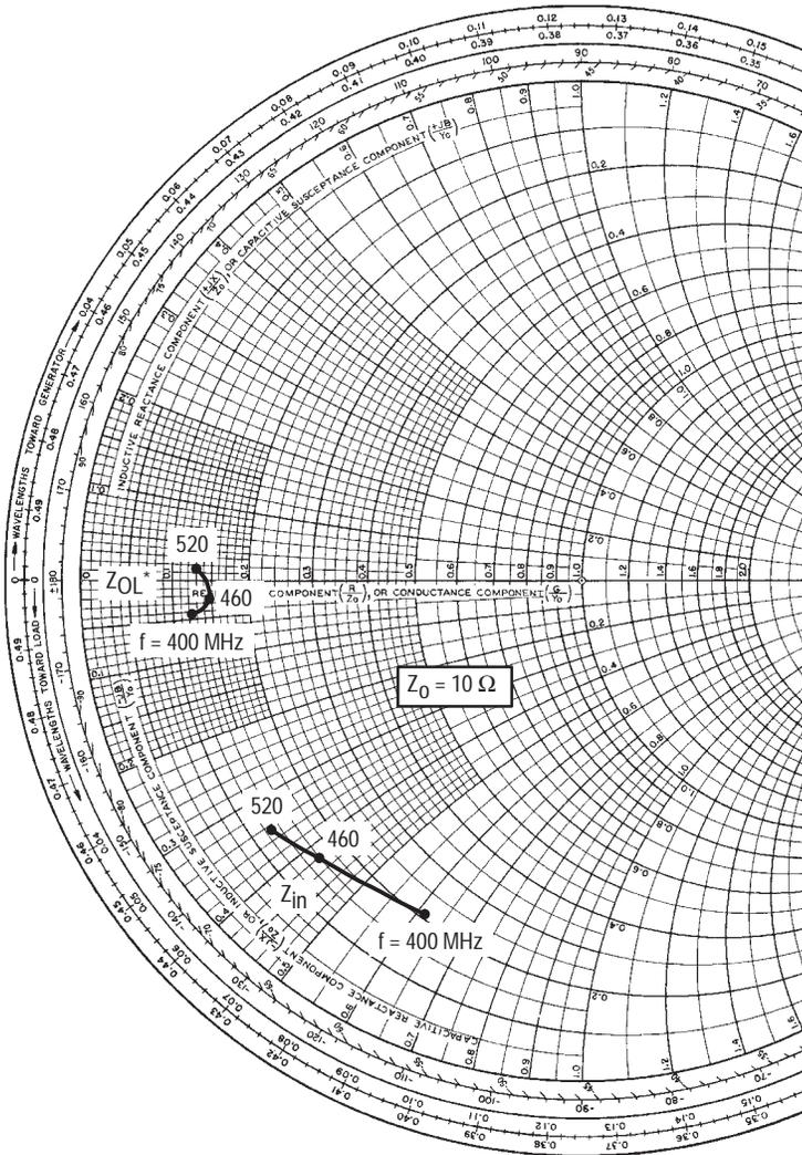
$V_{DD} = 12.5\text{ V}$ ,  $I_{DQ} = 100\text{ mA}$ ,  $P_{out} = 15\text{ W}$
