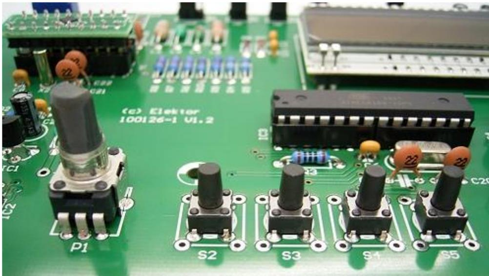
Anders als auf den Fotos in Elektor werden in der Serie kleinere Tasten mit höheren Knöpfen eingesetzt. Ein weiterer kleiner Unterschied: Die Kondensatoren C21 und C22 beim Uhrenquarz haben jetzt 22 pF. Diese Änderung geht auf einen Irrtum meinerseits zurück. Im Datenblatt steht 12 pF als parallele Kapazität, aber ich hatte übersehen, dass beide Kondensatoren in Reihe die halbe Kapazität haben. Zusammen mit den Leitungskapazitäten passt 22 pF besser.
