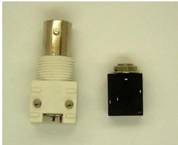
Der Platine liegen die beiden nicht bestückten Buchsen für den Antenneneingang und den Audioausgang bei. Das wurde so festgelegt, weil beide Buchsen alternativ zu den vorhandenen Schraubklemmen eingesetzt werden können und über den Platinenrand ragen. Jeder kann selbst entscheiden, wie die Platine eingesetzt werden soll.
