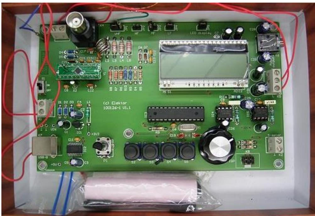
Der Antennentrafo ist direkt an zwei 4-mm-Buchsen angelötet.
