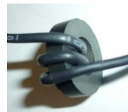
Два витка (снаружи) – 5 мкГн
