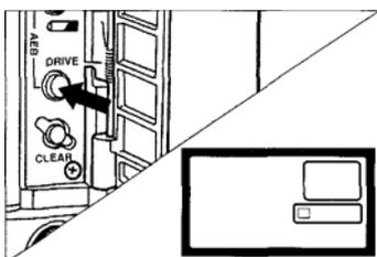
1. Откройте крышку под ладонью и нажмите на кнопку выбора режима протяжки пленки.
