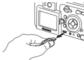
При отсоединении интерфейсного кабеля от разъема DIGITAL камеры обязательно беритесь за боковые поверхности разъема.
