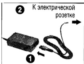
**4** Подсоедините кабель питания к компактному блоку питания и включите его в электрическую розетку.
