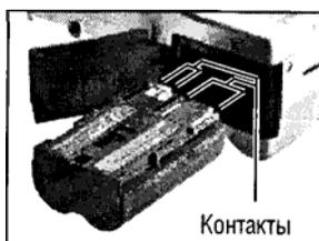
**3** Установите аккумулятор BP-511 и закройте крышку отсека аккумулятора.
