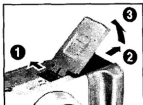
**2** Сдвиньте защелку крышки аккумуляторного отсека в направлении стрелки и откройте крышку.
