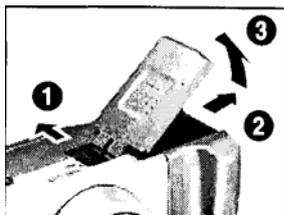
**2** Сдвиньте защелку крышки аккумулятора отсека в направлении стрелки и откройте крышку.
