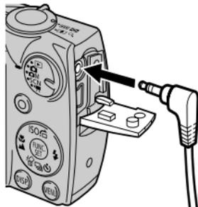
**3** Подключите другие разъемы AV-кабеля к разъемам VIDEO IN и AUDIO IN телевизора.
