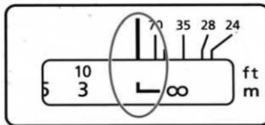
Чтобы компенсировать смещение фокусной точки в бесконечности, вызванное перепадами в температуре, можно повернуть кольцо со шкалой расстояний немного за пределы метки нормальной фокусировки на бесконечность.
