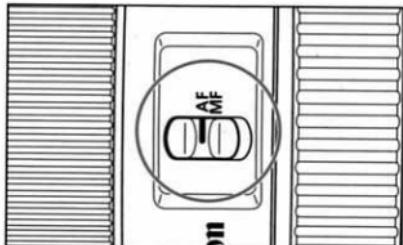
Для съемки в режиме автоматической фокусировки установите переключатель режимов фокусировки в положение AF. Чтобы использовать только ручную фокусировку, установите переключатель режимов фокусировки в положение MF и настройте фокусировку, поворачивая фокусировочное кольцо.
