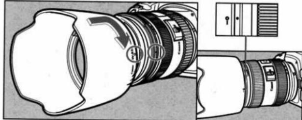
Бленда EW-83F не допускает нежелательные блики и свет на линзы объектива, а также защищает объектив от попадания на поверхность линзы дождя, снега и пыли. Чтобы подсоединить бленду, выровняйте метку позиции подсоединения на бленде по красной точке на передней части объектива, затем поверните бленду по часовой стрелке таким образом, чтобы красная точка на объективе совместилась с меткой фиксации бленды в креплении. При хранении объектива можно закрепить бленду на объективе в обратной ориентации.
