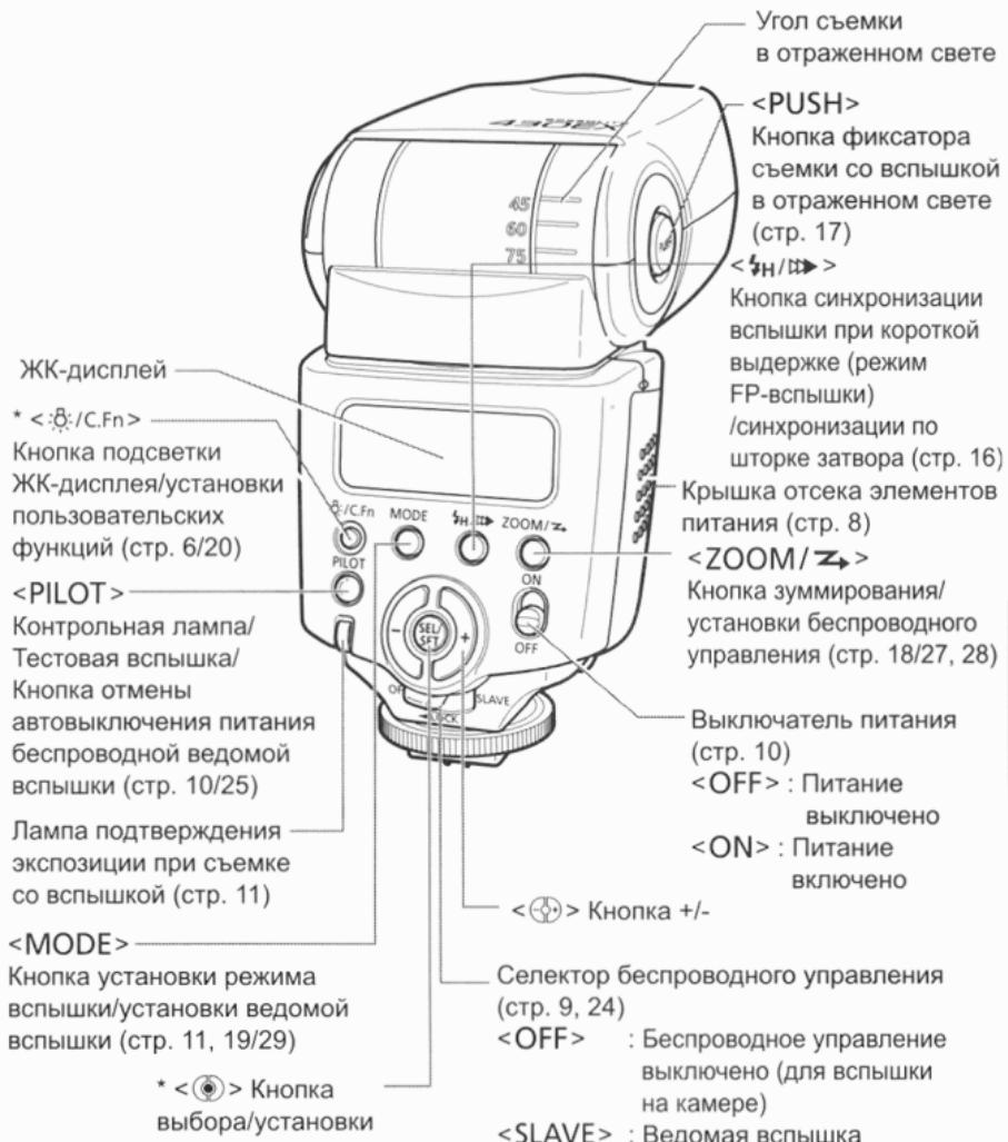
Кнопки, помеченные звездочкой, снабжены таймером, благодаря которому функция кнопки остается активной в течение 8 с ( $\text{Fn}$ ) после отпускания кнопки. Длительность подсветки < $\text{Fn}$ > составляет 12 с.
