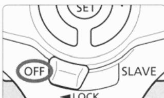
Селектор дистанционного управления предназначен для переключения между режимом обычной съемки со вспышкой и режимом съемки со вспышкой с дистанционным управлением. Для обычной съемки со вспышкой установите переключатель дистанционного управления в положение <OFF>.
